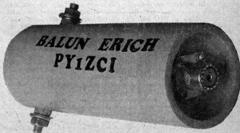
FOTO II — Aspecto do balun já pronto para ser utilizado.
